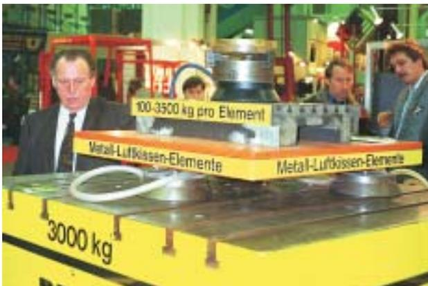
Metall-Luftkissen-Elemente gleiten über die Nuten eines Maschinentisches
